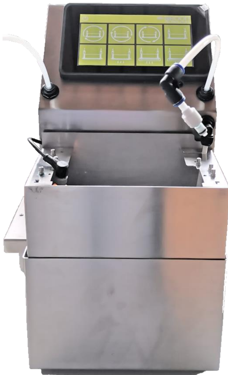
Fertiger Prototyp der Druckkopfspüleinheit
