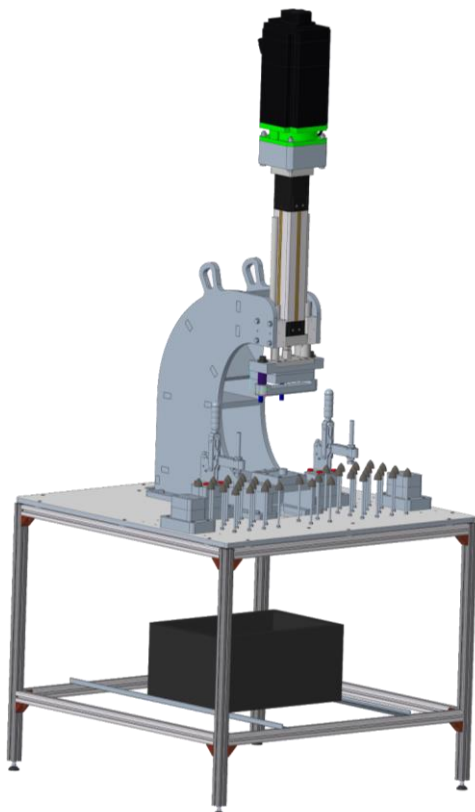
Abbildung 2: 3D-Modell Lösung 1 mit Elektrozyylinder
