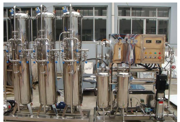
Reinstwassererzeugungsanlage Quelle: productshopper.at
