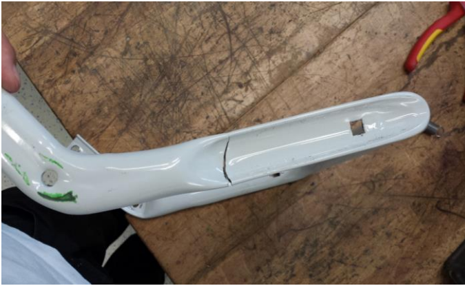
Hier sieht man den auftretenden Riss am Lenkerunterteil.
